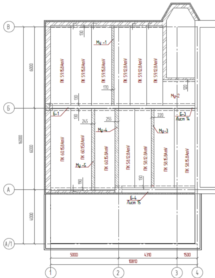
Схема расположения плит перекрытия на отм. +6,600
